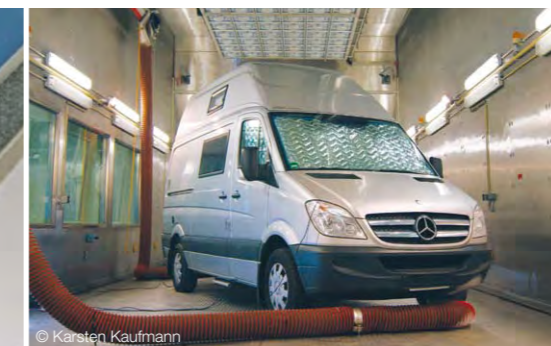
Mercedes Sprinter avec toit rigide SCA 472 dans la chambre froide
